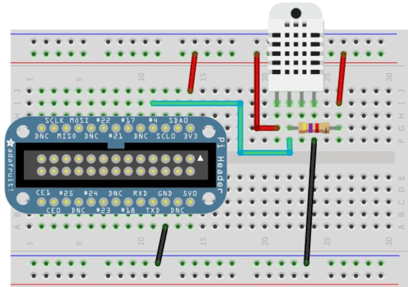
Time to start exploring more sensors with the Raspberry Pi and Beaglebone Black! Today we'll be checking out the [DHT11](http://adafru.it/386) (<http://adafru.it/386>), [DHT22](http://adafru.it/385) (<http://adafru.it/385>) and [AM2302](http://adafru.it/393) (<http://adafru.it/393>) humidity and temperature sensors available from Adafruit
