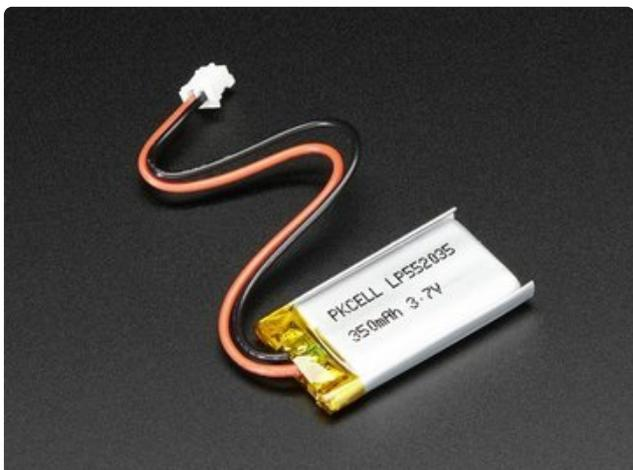
**Battery** - A small lipoly battery like a [350mAh version](http://adafru.it/3501) (<http://adafru.it/3501>) is easy to hide between the petals of the flower. Or grab a [battery extension cable](http://adafru.it/1131) (<http://adafru.it/1131>) and [larger battery](http://adafru.it/1578) (<http://adafru.it/1578>) or [3xAAA battery pack](http://adafru.it/727) (<http://adafru.it/727>) for more power options.
