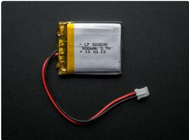
Lithium Ion Polymer Battery - 3.7v 500mAh (<http://adafru.it/1578>)
