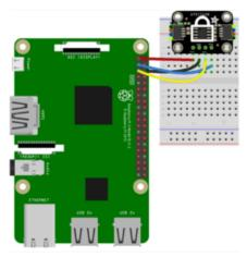
Pi 3V to sensor VIN (red wire)
