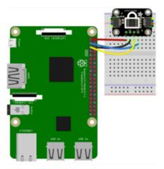
Pi 3V to sensor VIN (red wire)
