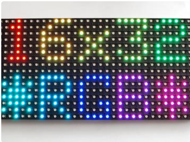
Adafruit 16x32 RGB LED Matrix ( http://adafru.it/420 ) - we're using 3 of them!
